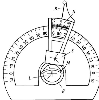
Differenziergerät. Abb. 2: Derivimeter nach Ott
